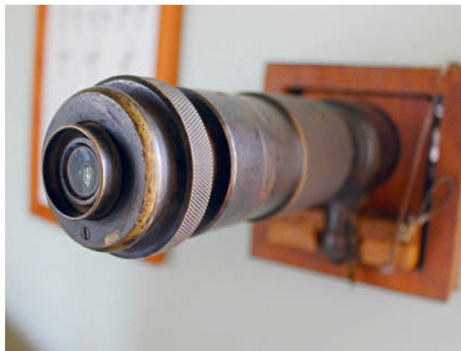
Durch so ein feststehendes Fernglas konnte der Spätelegrafist die nächste Station im Auge behalten und dem Kurbeltelegrafisten Meldung machen.
